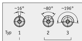
Ángulo de conexión de las tres levas de cambio: especial para el límite de la posición final (1), para funciones de mando (2,3).
